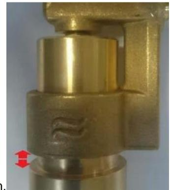
quemadores de 6 y 8KW. En el caso del quemador de 3.5KW, esta distancia debe ser de 12 mm.
