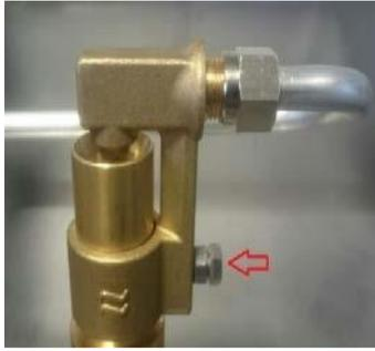
4 - Retire el tubo y el conjunto de soporte del inyector piloto.
