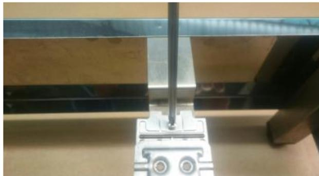
Figure 2- Retrait des vis et des brûleurs
