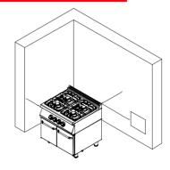
THE MIN. DISTANCE BETWEEN THE TUBE AND THE DEVICE SHOULD BE 50 CM
