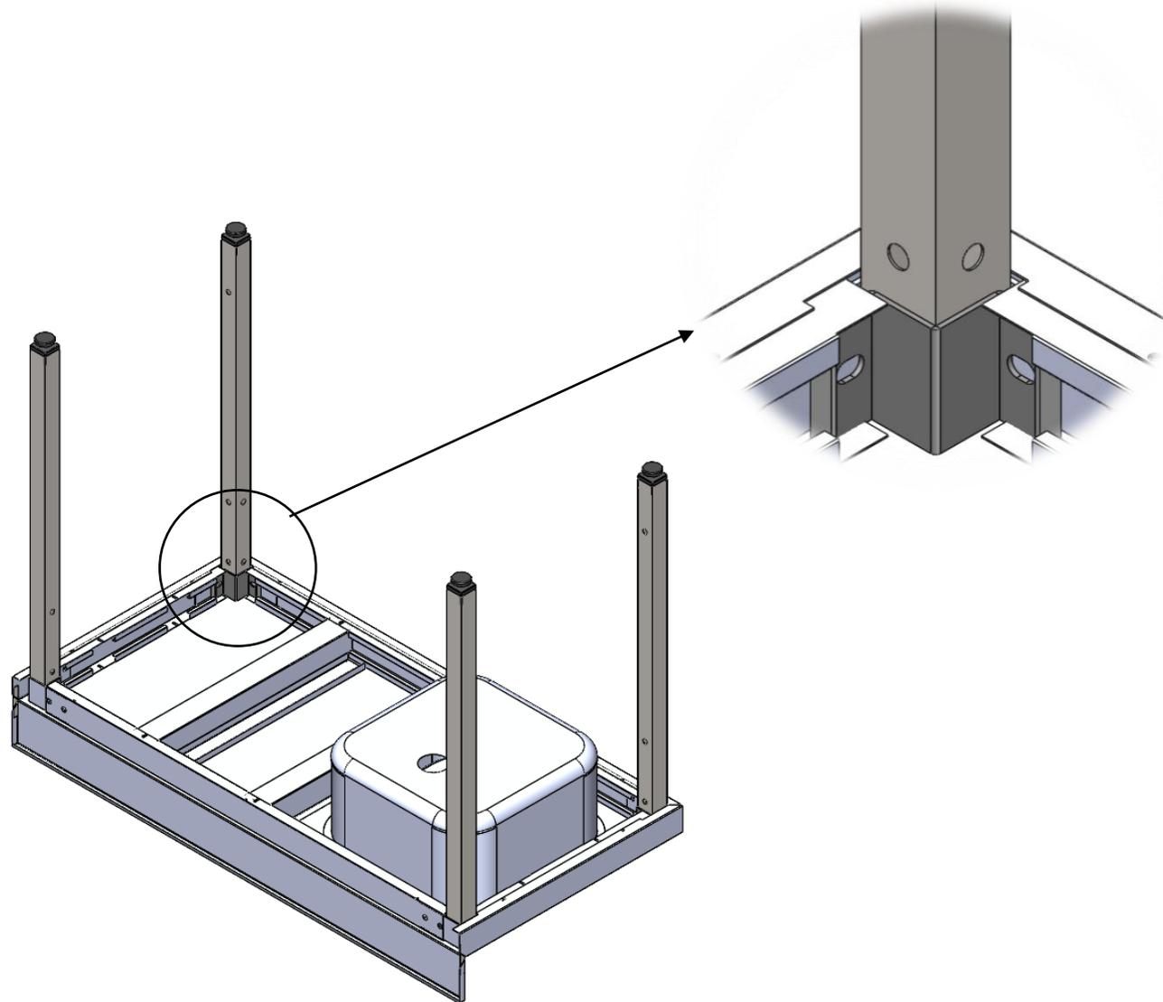
2º Serrer les cadres des jambes avec 4 vis M8x20 et des rondelles M8;
