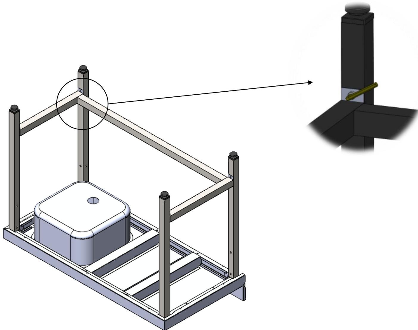
3<sup>o</sup> Fixez les panneaux avec 12x vis M8x20 et 12x rondelles;
