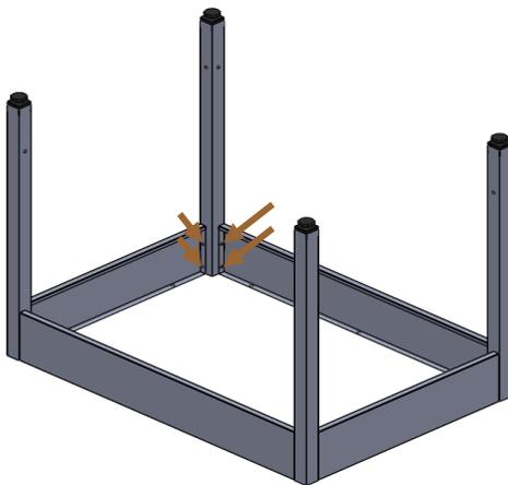
3. Appliquer les rails arrière et latéraux comme indiqué sur l'image (appliquer 6 vis M6);
